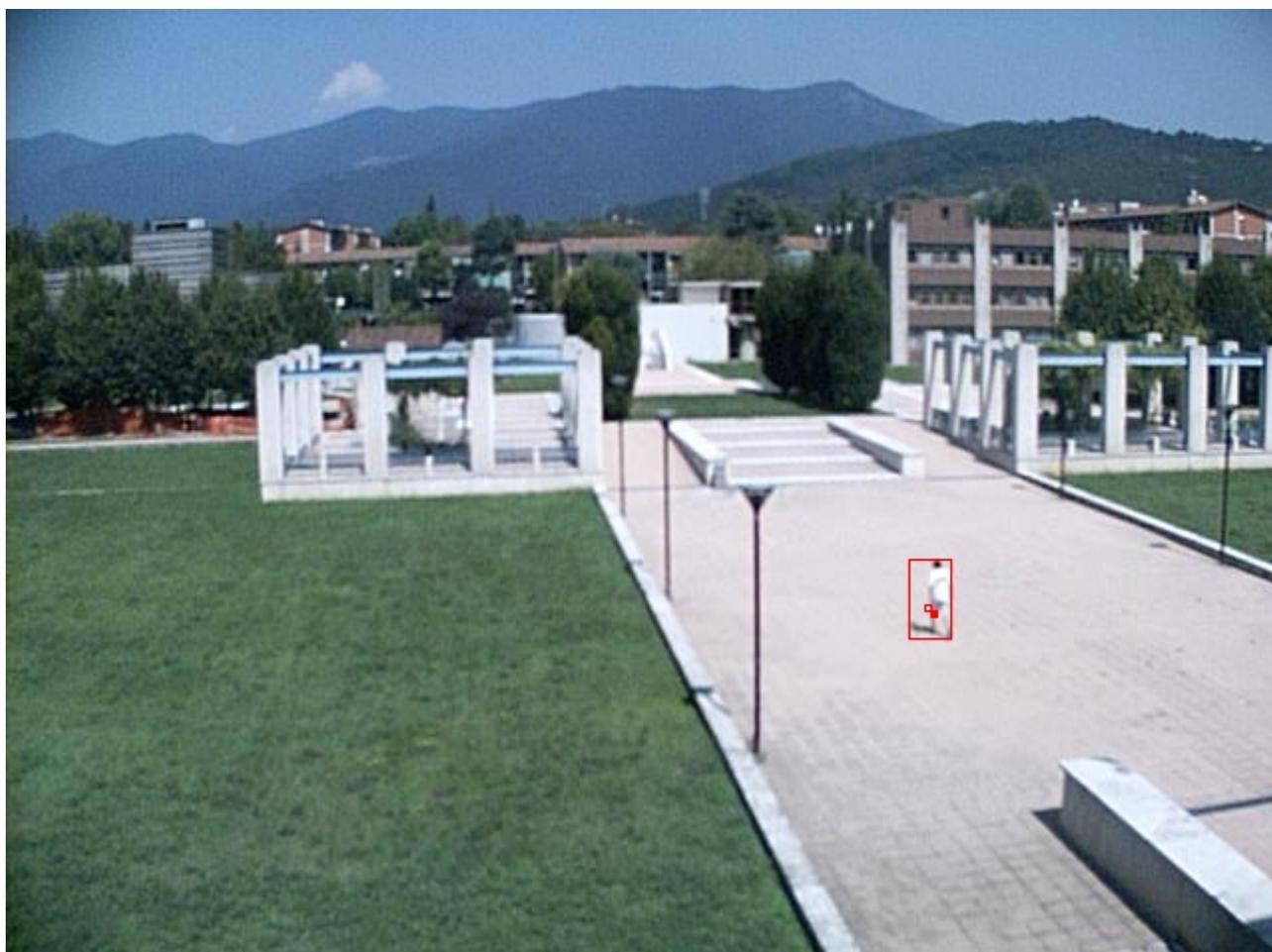
L'immagine sopra riportata è la settima della sequenza. Anche in questo frame viene rilevato un fenomeno intrusivo posizionalmente compatibile con quello rilevato nel frame precedente. Il Thoth assegna all'intruso corrente un numero di tracciamenti consecutivi pari a 7.
