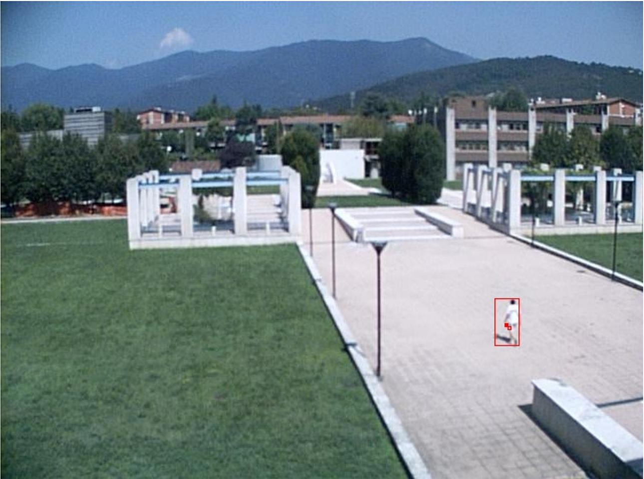
L'immagine sopra riportata è la quinta della sequenza. Anche in questo frame viene rilevato un fenomeno intrusivo posizionalmente compatibile con quello rilevato nel frame precedente. Il Thoth assegna all'intruso corrente un numero di tracciamenti consecutivi pari a 5.
