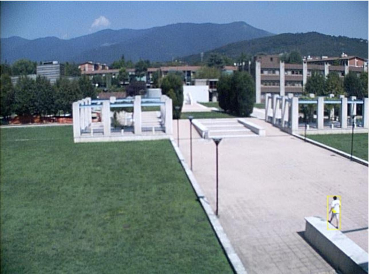
L'immagine sopra riportata è la terza della sequenza. Anche in questo frame viene rilevato un fenomeno intrusivo posizionalmente compatibile con quello rilevato nel frame precedente. Il Thoth assegna all'intruso corrente un numero di tracciamenti consecutivi pari a 3.
